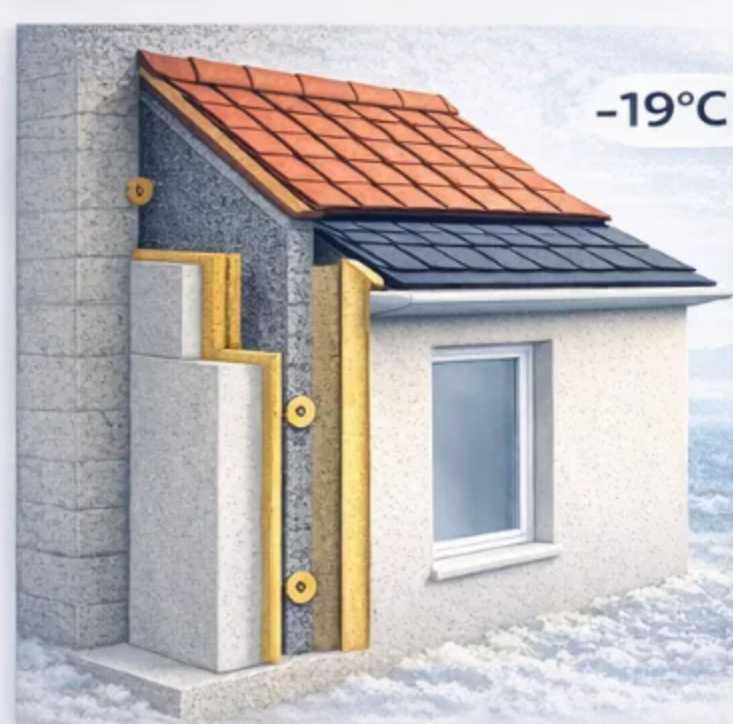
ISOLATION THERMIQUE PAR L'EXTÉRIEUR
